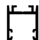
Затварящ колона - 21x26 мм
